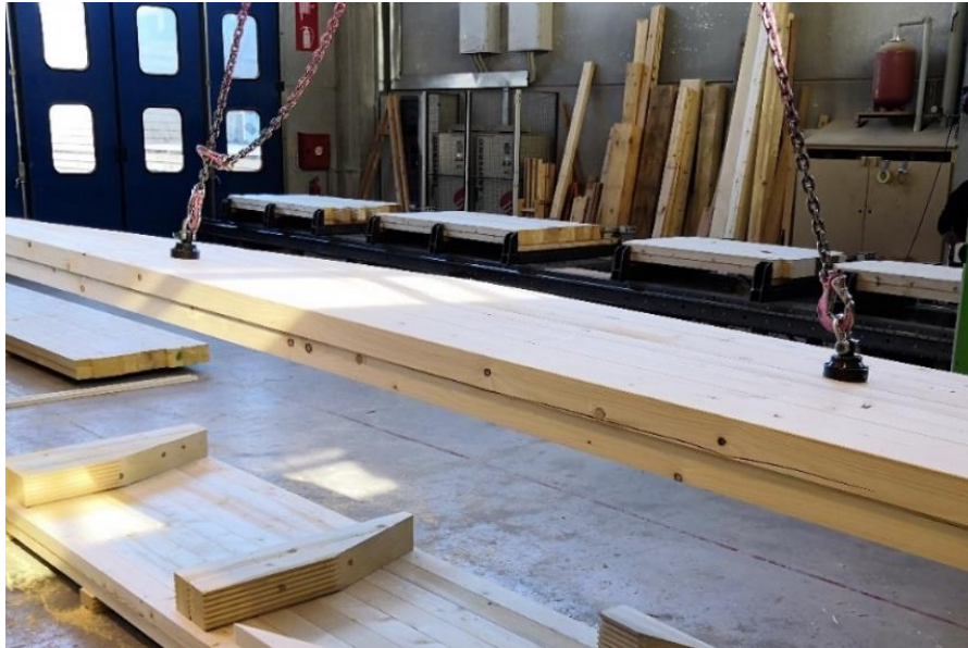
Abbildung 11: Die einzelnen Vollholzdecken können mit dem sogenannten „Pick“ (Sihga) oder anderen Hebeankern angehoben werden.
